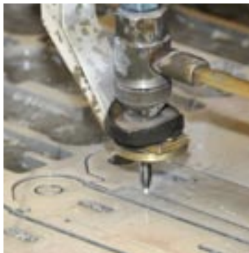
... sedan skär vattenmaskinen ut detaljer i det rostfria stålet.
