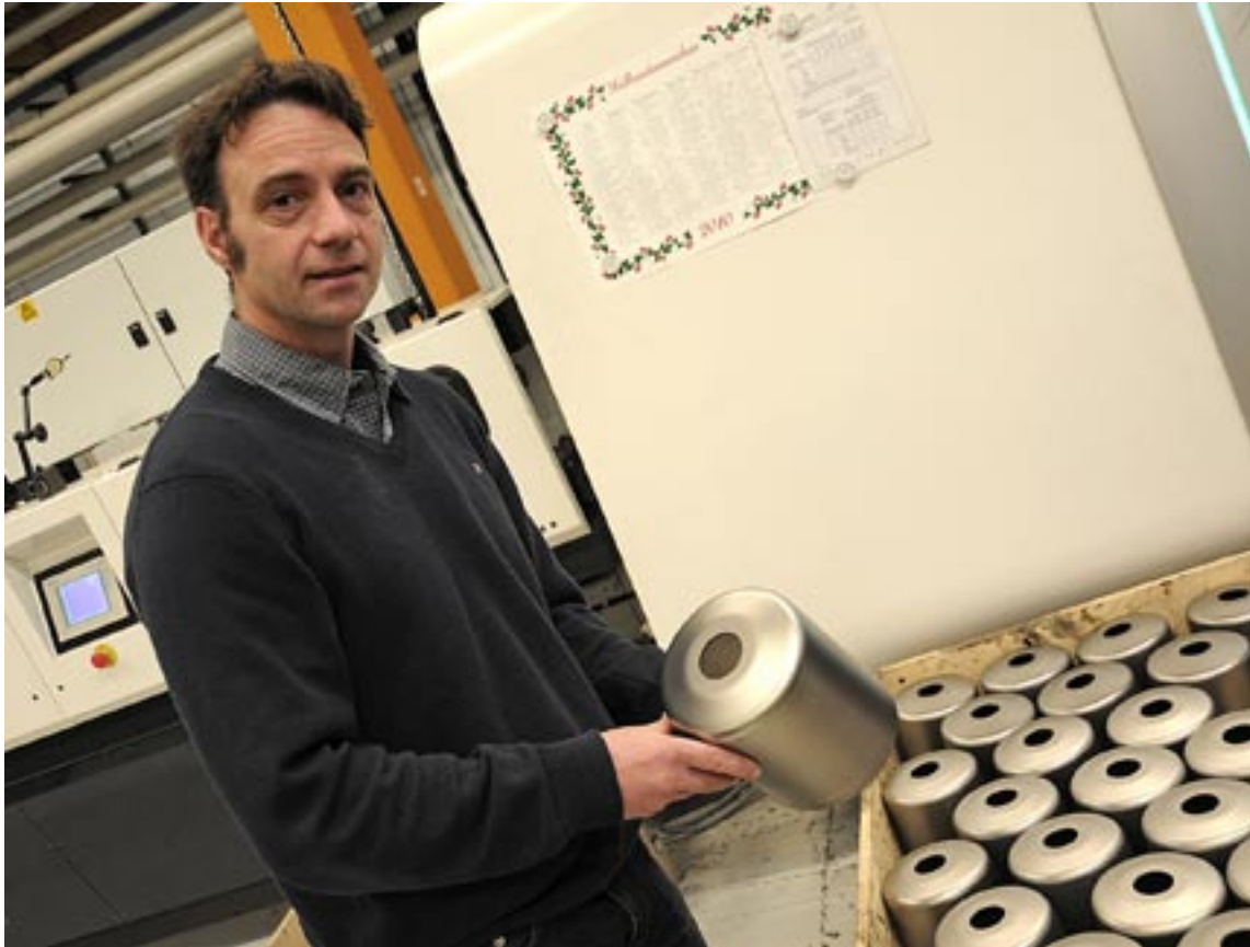
Stefan Örjes visar upp en djupdragen detalj med en godstjocklek på 4 mm. Att man ur en 350 x 4 mm rostfri plåtrondell kan forma så här imponerar på en novis. FOTO: GUNNAR FRISELL
